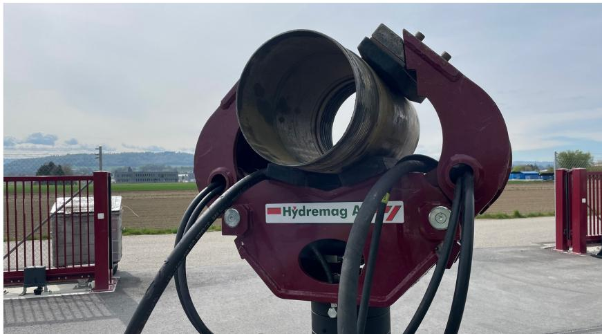
Standard Greifer mit demontierbaren Gummieinsätzen und Druckbegrenzung zum Manipulieren von dünnwandigen, beschichteten Rohren.
